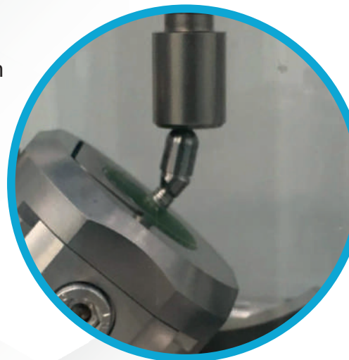
Máquina de ensayo de fatiga de DESS® (Zoom)
